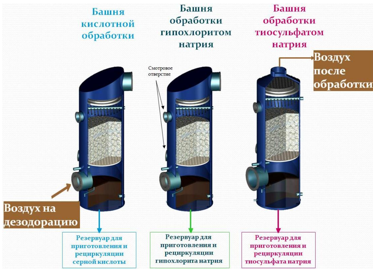
Рисунок 4 – Принципиальная схема очистки воздуха от дурнопахнущих газов
