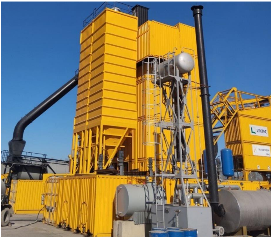
Рисунок 3 – Внешний вид асфальтосмесительной установки контейнерного (блочного) типа CSM 3000/6
