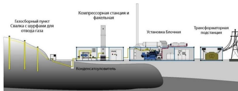
Рисунок 3. Схема основных зданий и сооружений для осуществления активной дегазации полигонов и использования свалочного газа в качестве топлива
